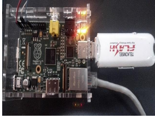
Gambar 2.2 USB Modem terpasang pada BCM2835
